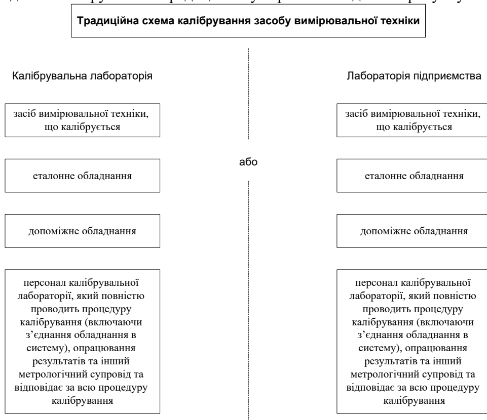
Рисунок 1. Традиційна схема калібрування засобів вимірювальної техніки.
