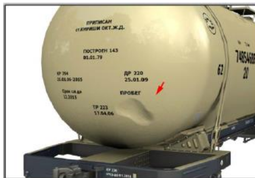
Рис.3 – Пошкодження котла цистерни
