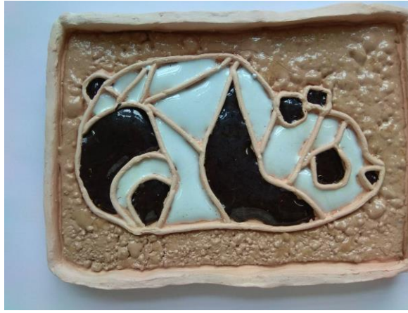
Рисунок 2 – Дефекти, що можуть виникати при фьюзингу на керамічній основі: погане розтікання склошару та скипання
