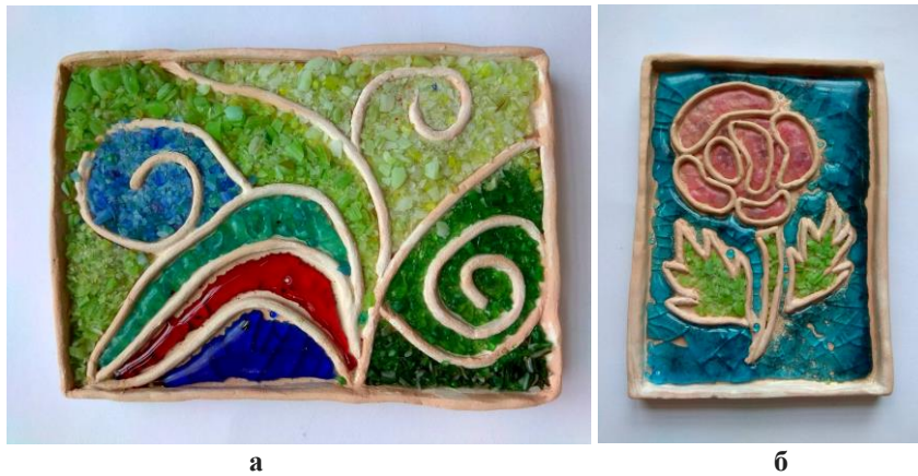
Рисунок 1 – Дефекти, що можуть виникати під час фюзингу на керамічній основі: розтріскування, збірка, відсутність плавління
