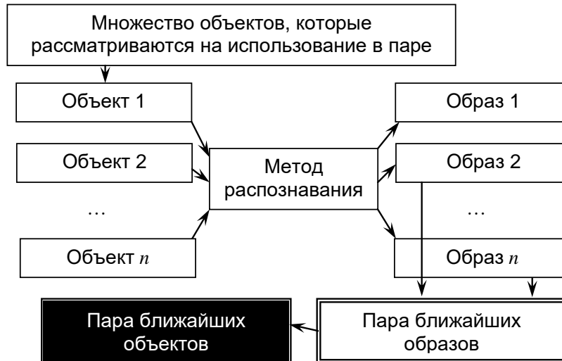
Рис. 1. Выбор наиболее близкой пары шин из имеющихся в наличии
